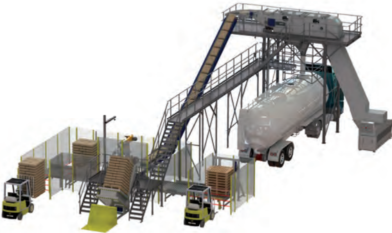
Vollautomatischer Galahad-Automat mit Mehrkopfroter und zusätzlichem Hubkipptisch
