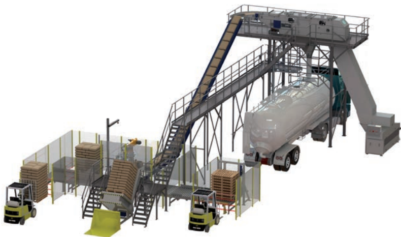
Machine Galahad entièrement automatique avec robot multi-têtes et table élévatrice-inclinable supplémentaire
