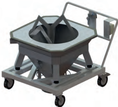
Mobiles System mit Schneidvorrichtung zur Befüllung von Bodensilos
