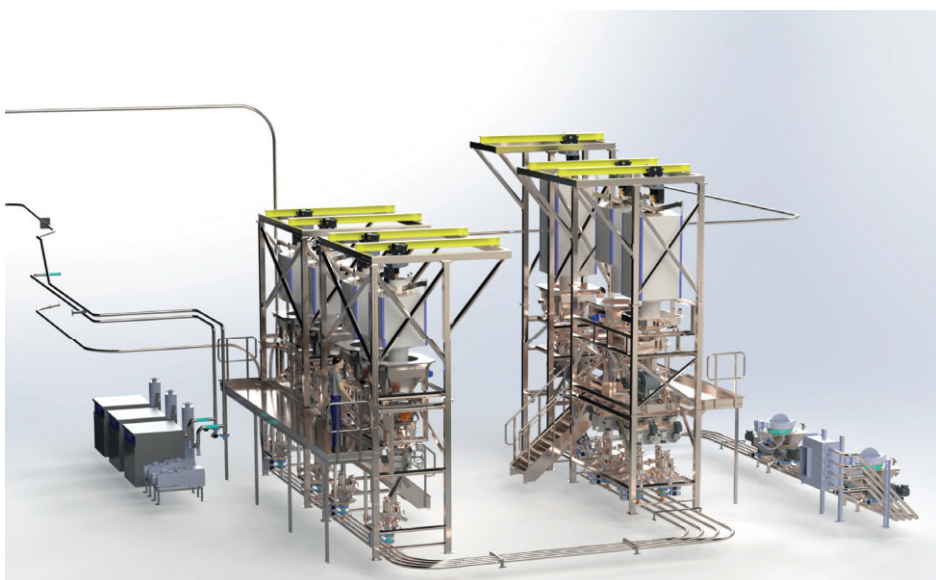
De complete installatie met aanvoer van droge ingrediënten naar vier specialiteitenlijnen in beeld. De succesvolle realisatie resulteerde voor TBMA al in meerdere vervolgoopdrachten.
