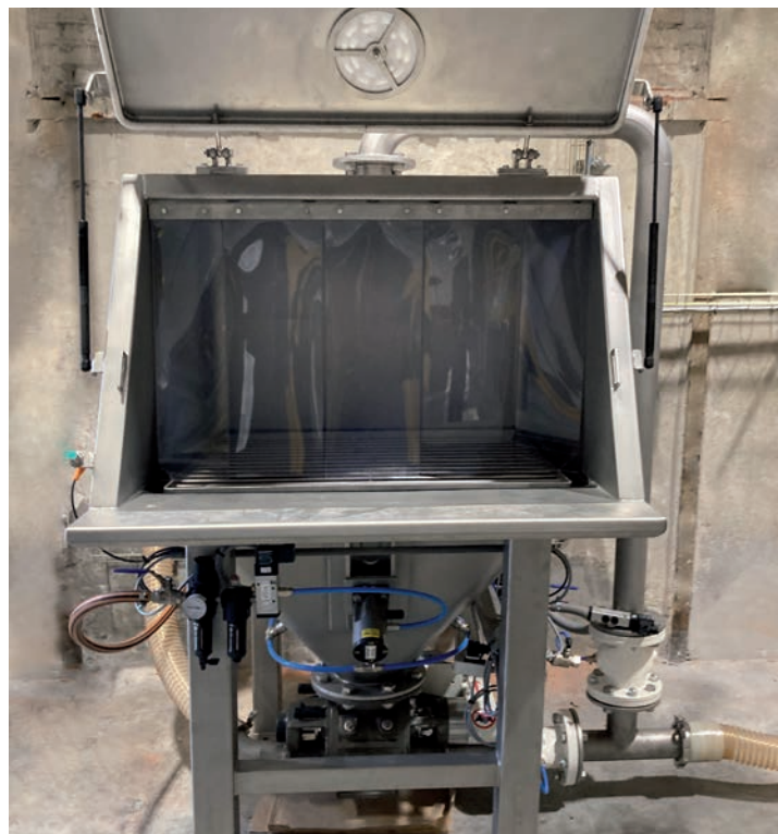
Afb. 2 Het stortraam met kunststof stroken beperkt de benodigde stofafzuiging
