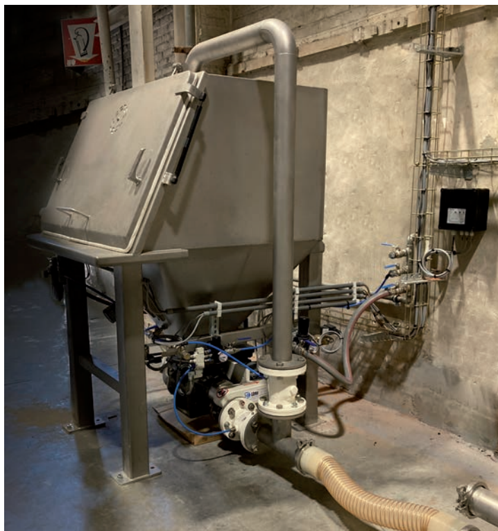
Afb. 1 Het TBMA zakkenstortkabinet met daaronder een HGR150 doorblaassluis
