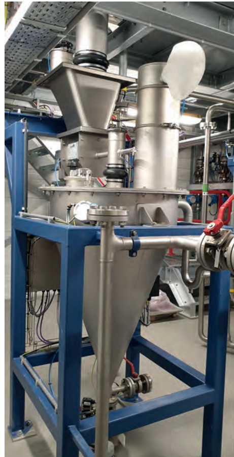
Afb. 4 Vortex hopper voor het vermengen van het actiefkool met water.
