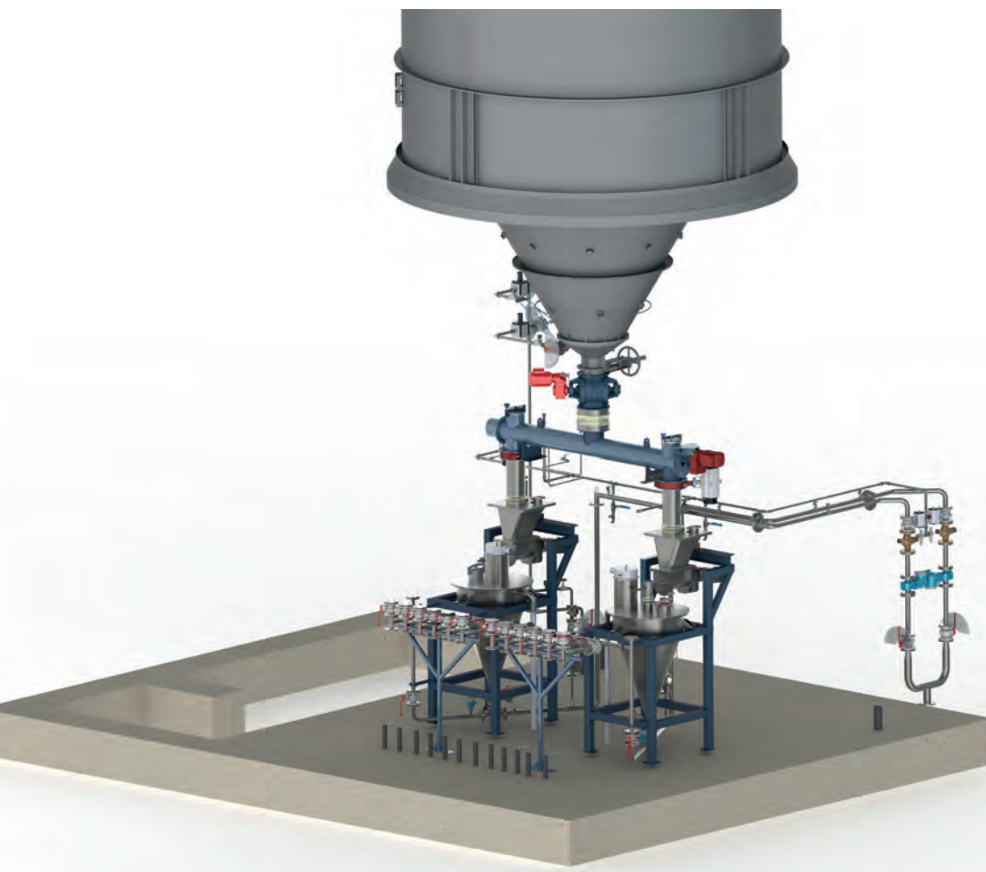
Afb. 1 De opslagsilo met daaronder het uitdraagsysteem en twee parallel opgestelde feeders met vortex-vaten voor de slurrybereiding.
