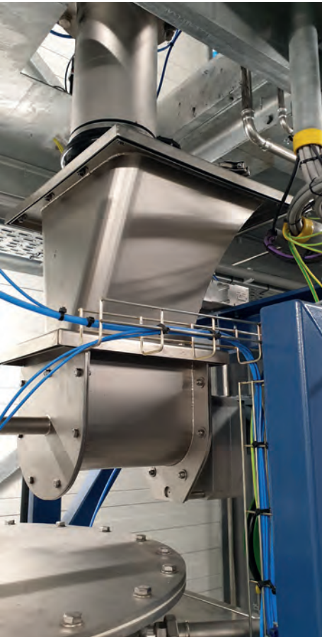
Afb. 3 Loss-in-weight (LIW) feeder met doseerschroef.
