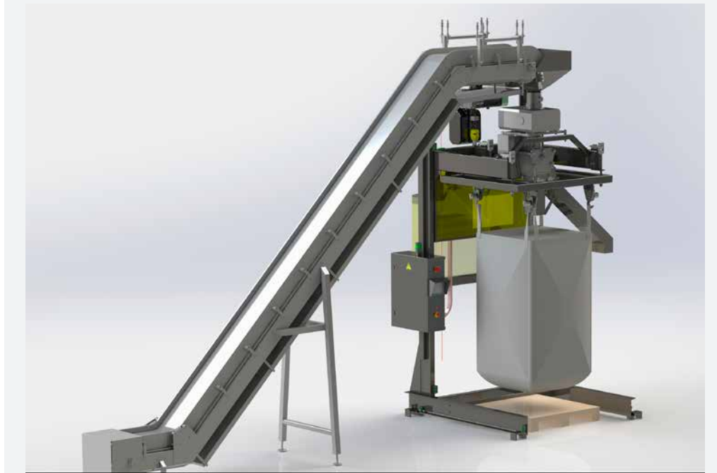
TBMA ontwierp de vulinstallatie met een iets kleinere storthoek, minder steile vulbuis en steunen aan het plafond, zodat hij in de compacte fabriekshal past.
