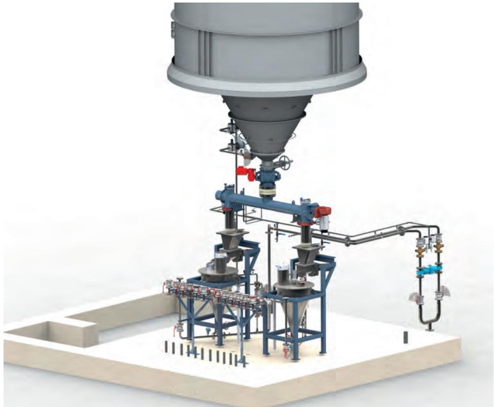
Afb. 2 Illustratie van een recent opgeleverde PACAS-installatie (Powdered Activated Carbon in Activated Sludge) voor een biologische waterzuiveringsinstallatie van Waterschap Aa en Maas. De installatie bestaat uit onder andere een opslagsilo met weegapparatuur, doseersluis, schroeftransporteur, LIW-feeders, Vortex-vaten en ejecteurs. TBMA deed het ontwerp, engineering, levering van de componenten en de opbouw van de installatie.
