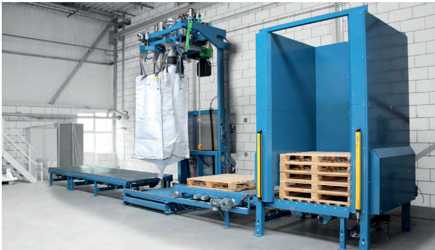
Afb. 3 Big bag afvullijn inclusief palletdispenser en conische triltafel.
