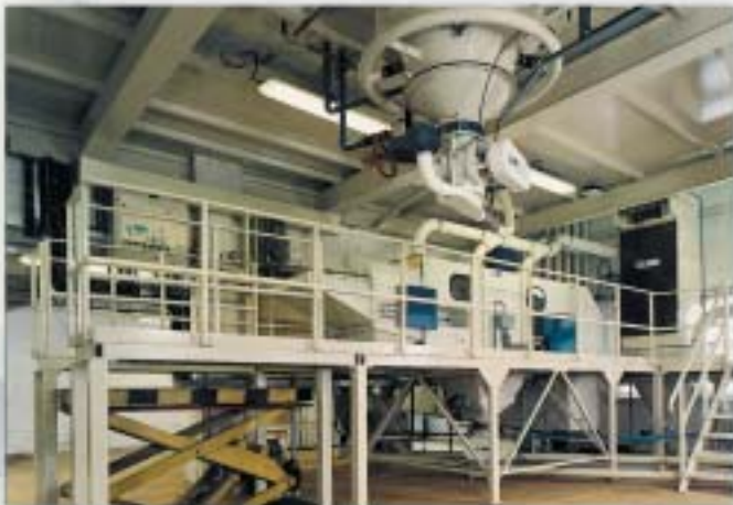
■ "GALAHAD" zakkensnij-installatie compleet met heftafel, balenpersen en filterinrichting t.b.v. pigmenten en fillers verwerking.
