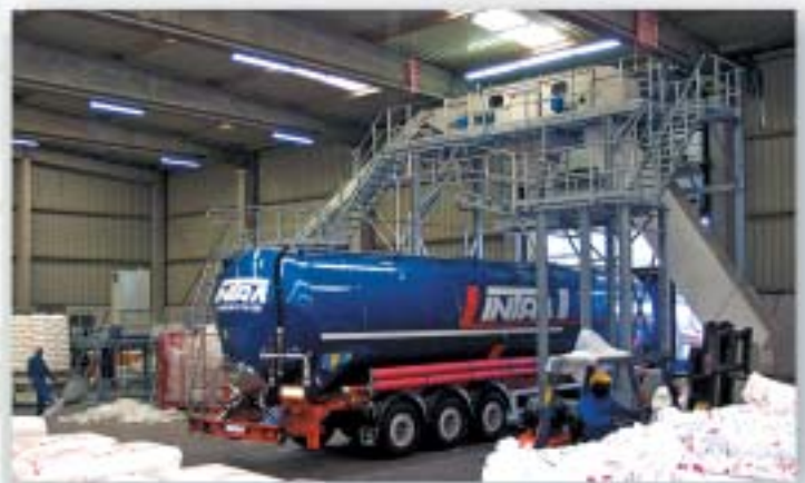
■ "GALAHAD" zakkensnij-installatie compleet met heftafel, balenpersen en filterinrichting t.b.v. pigmenten en fillers verwerking.
