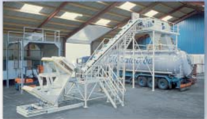
■ Overslaginstallatie voor bulkwagens met "GALAHAD" zakkenleeg machine
