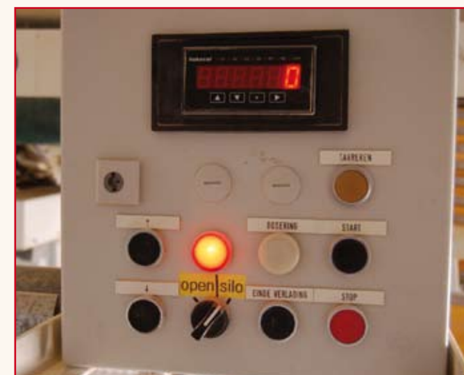
Bedieningspaneel met keuzeknop: open of silo-wag en
