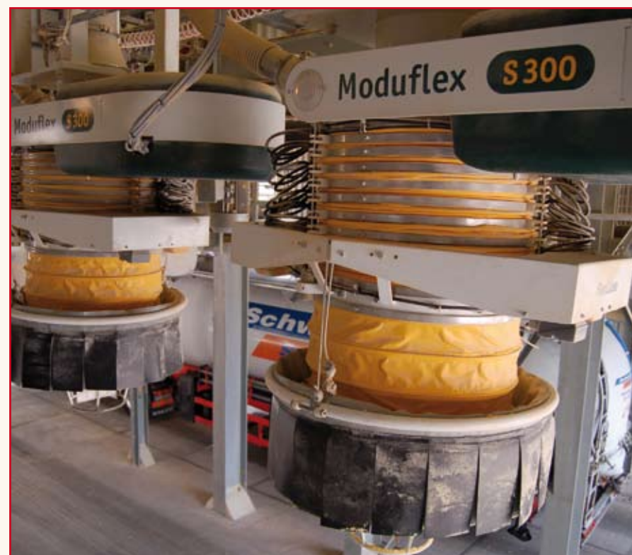
De twee beladingsbalgen met de rok omhoog: perfect voor het vullen van bulkwagens
