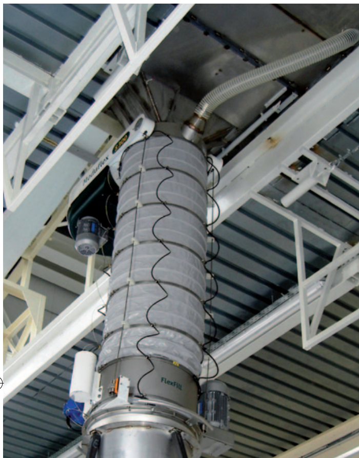
Afb. 1 Een explosie veilige beladingsbalg type HDF400 voor de firma Luicia
